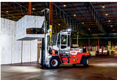
Klämtrucken kan lyfta upp till fyra balar pappersmassa på två ton vardera.
